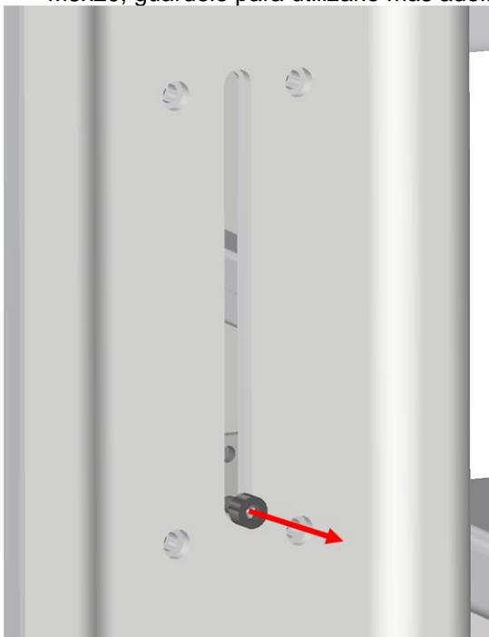
2. Monte el herraje con 4 tornillos M6x30 + arandelas (incluidas) en los 4 orificios roscados del elevador de inodoro. Apriete ligeramente los tornillos para que el herraje pueda moverse libremente hacia arriba y hacia abajo por las ranuras. Esto se aprieta más adelante.
